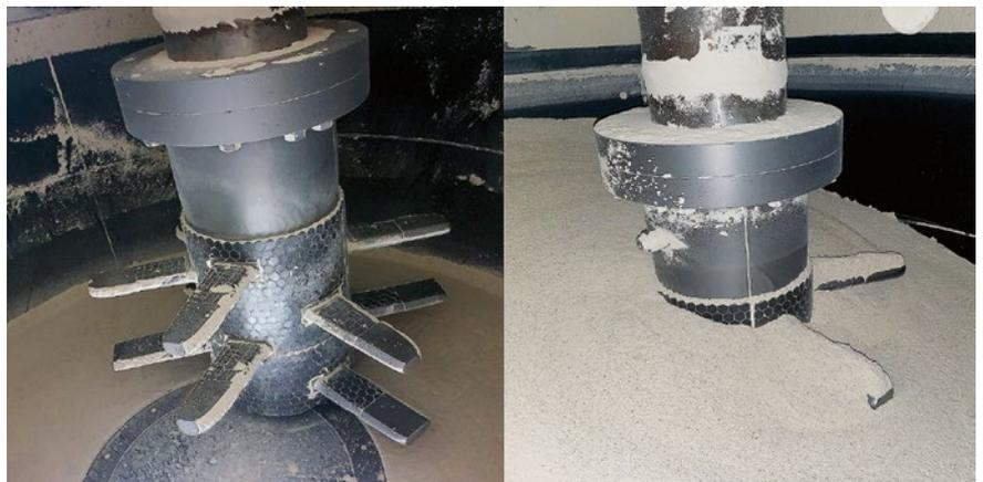
Bild 2 Das Mischwerkzeugsystem nach vier Jahren Betrieb – mit und ohne Material im Inneren des Mixers. (© Dörentrup Feuerfestprodukte)
